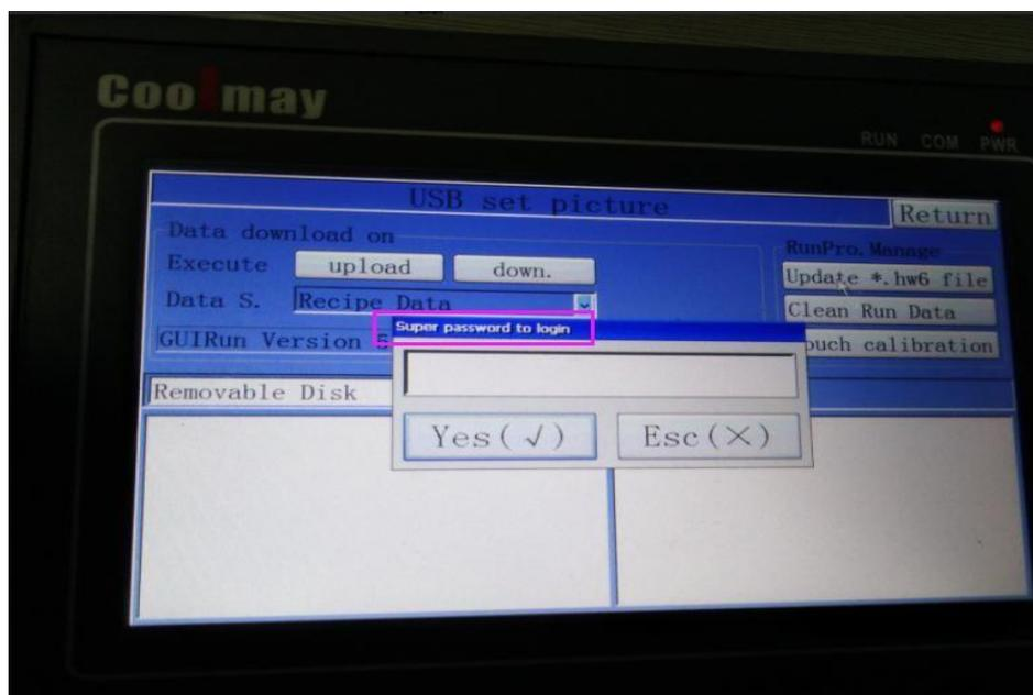
6. Después de la confirmación, puede encontrar HW6 en la esquina inferior derecha, luego haga doble clic en el cuadro de confirmación emergente, la barra de progreso se actualiza automáticamente.
