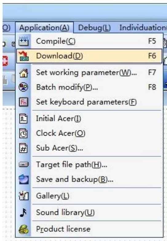
6. Aparecerá la ventana de descarga. Cuando la conexión HMI está bien, la configuración de IP está bien, luego espera el símbolo del sistema de descarga y luego haz clic en Descargar.
